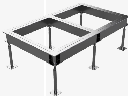
Modul-Rahmenkonstruktion mit Doppelprofil bis 20.000 N Punktlast und 40.000 N/m Linienlast
